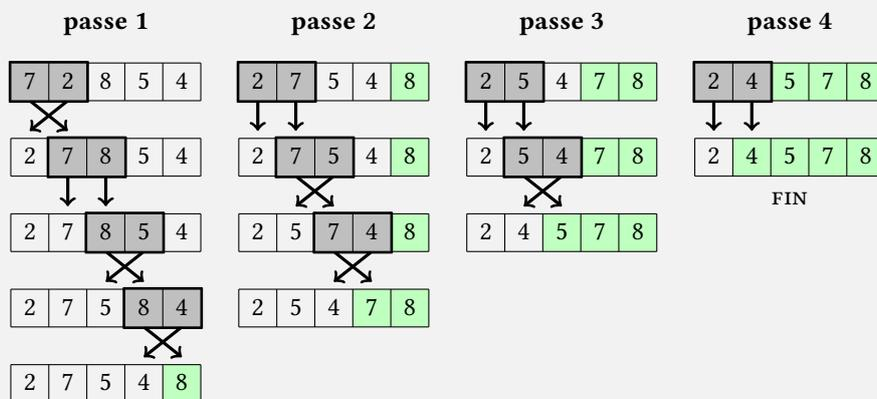
On peut donc voir le tri à bulle comme une variante du tri par sélection, où on commence par positionner la valeur la plus grande à sa position correcte, puis on répète le procédé sur la sous-liste qui s'arrête juste avant ce dernier élément. Notons enfin que si durant une passe on n'a fait aucun échange, la liste est triée, et on peut donc omettre les passes restantes.
